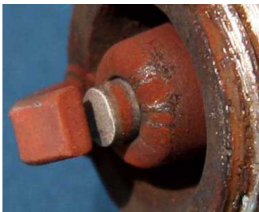
Рисунок 3 – Примеры неисправных свечей зажигания
