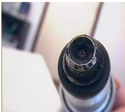
Рисунок 2 – Примеры загрязнения распылителя форсунок смолистыми отложениями
