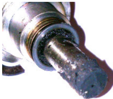
Рисунок 2 – Примеры загрязнения распылителя форсунок смолистыми отложениями
