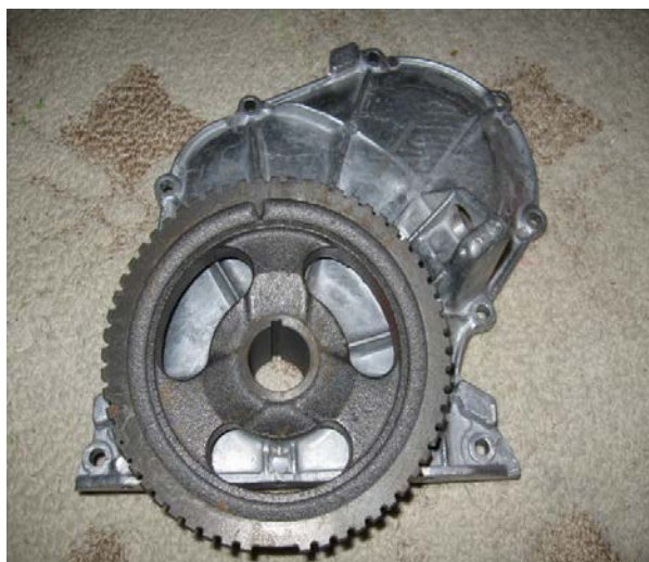
Рисунок 6 – Передняя крышка коленчатого вала и шкив, необходимые для установки ДПКВ
