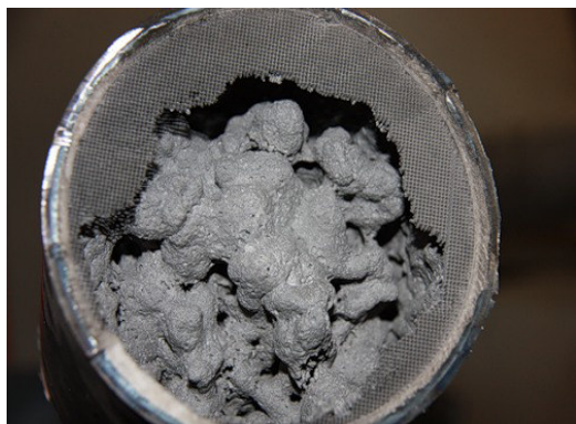
Рисунок 4 – Пример оплавления основы нейтрализатора
