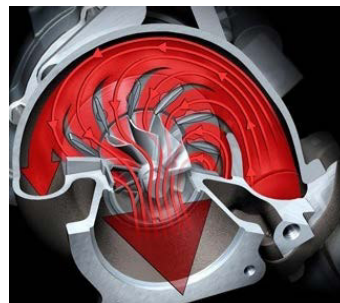
Рисунок 2 – Движение отработавших газов в каналах турбины радиально-осевой
