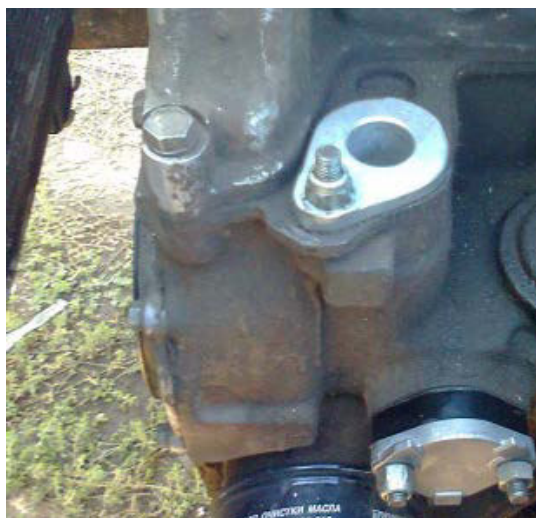
Рисунок 5 – Расположение заглушек трамблера и бензонасоса
