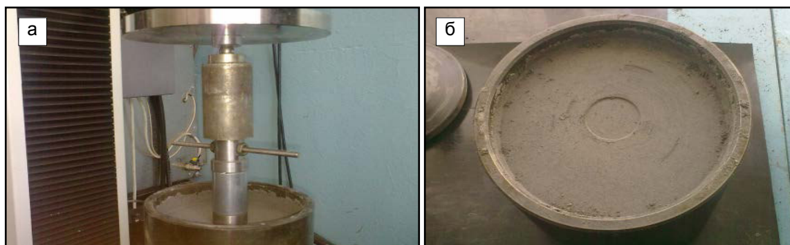
Рисунок 2 – Определение модуля упругости ЗШС: а) образец в нагружающем устройстве; б) – след от штампа
