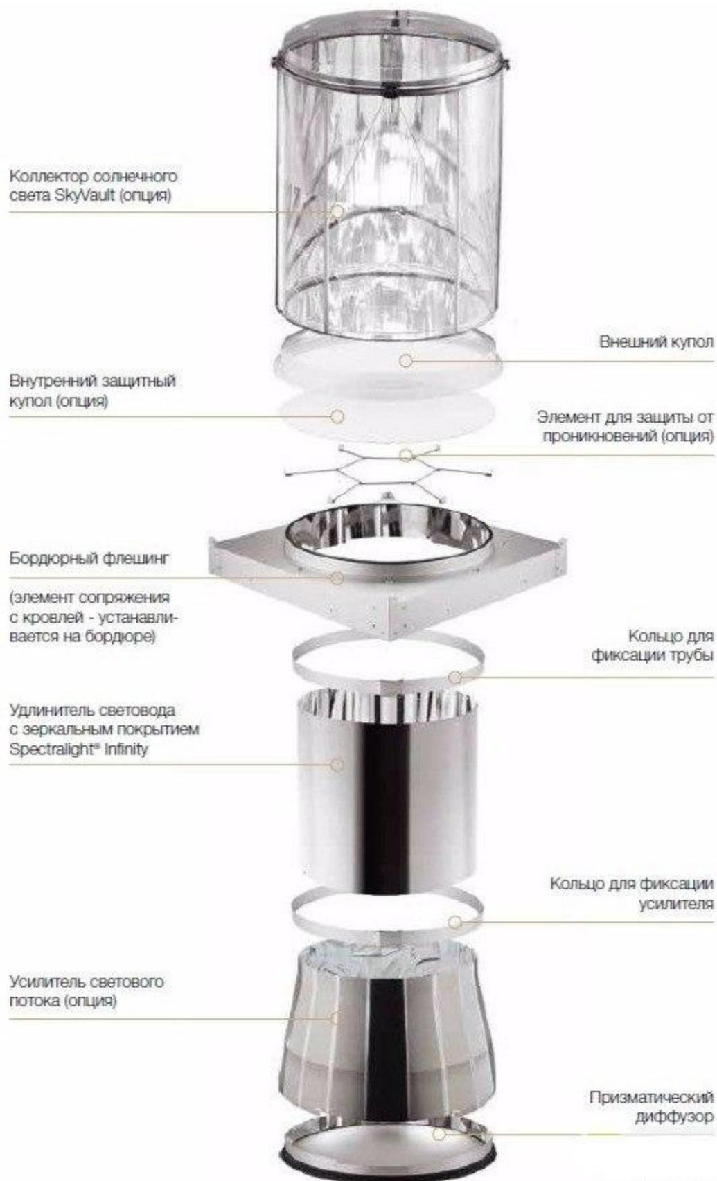
Рис.1. Устройство системы
