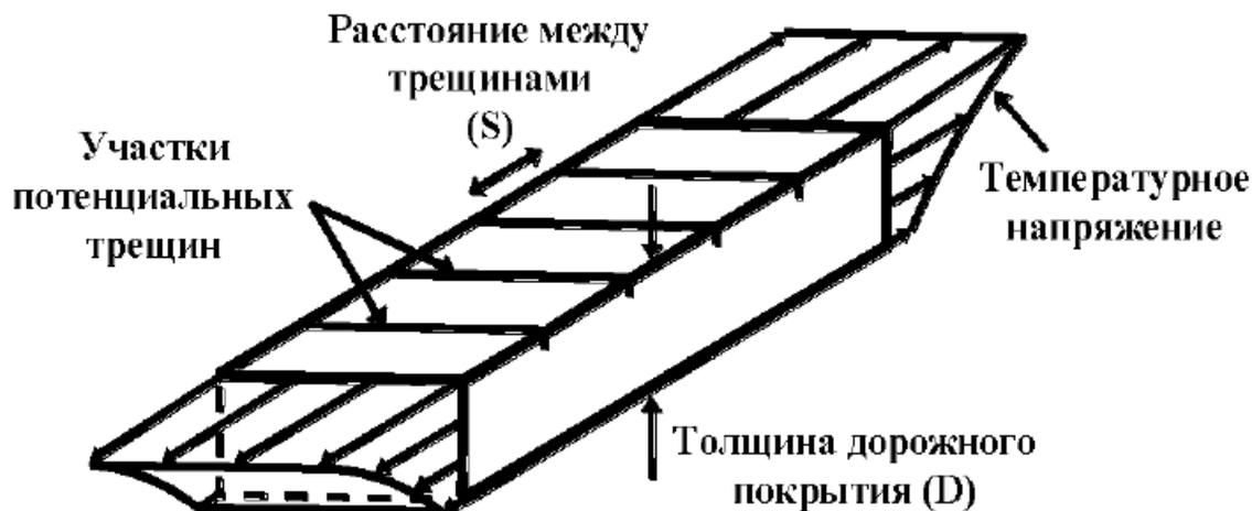
Рис. 2. Схема физической модели трещинообразования
