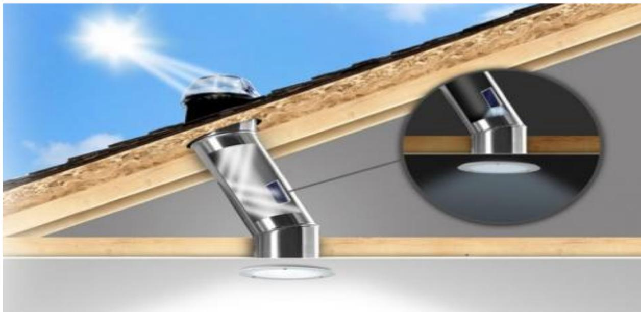
Рис. 2. Устройство системы Solatube
