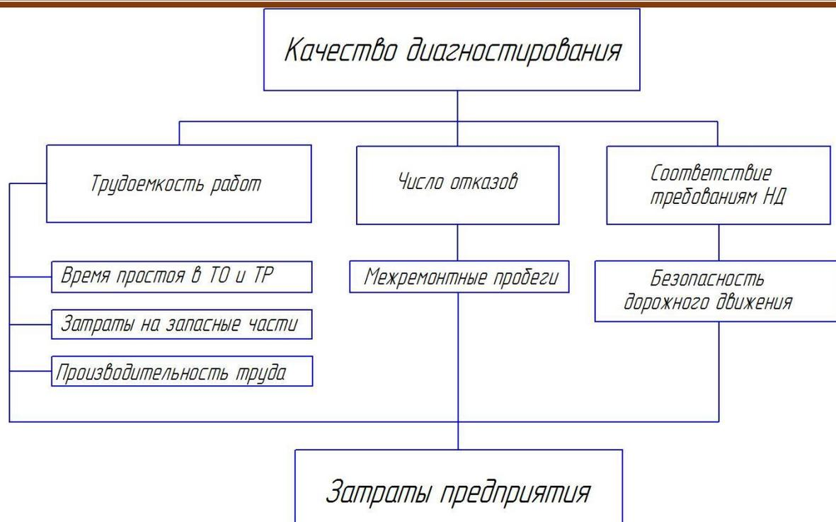
Рисунок 2 – Блок-схема связей влияния качества диагностирования автомобилей с эксплуатационными факторами автомобилей
