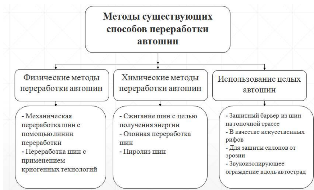
Рисунок 1 – Методы переработки автопокрышек
