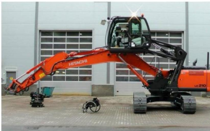
Рисунок 1 – Экскаватор с подъемной кабиной
