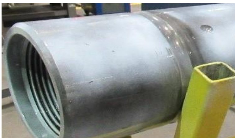
Рисунок 5 – Область нанесения магнитопорошковой суспензии
