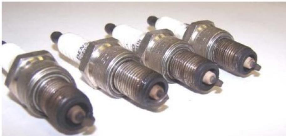
Рисунок 9 – Общий вид свечей зажигания после работы двигателя на ТВС.
