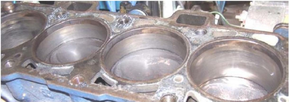
Рисунок 8 – Внешний вид камеры сгорания со стороны блока цилиндров после работы двигателя на топливо - водной смеси.
